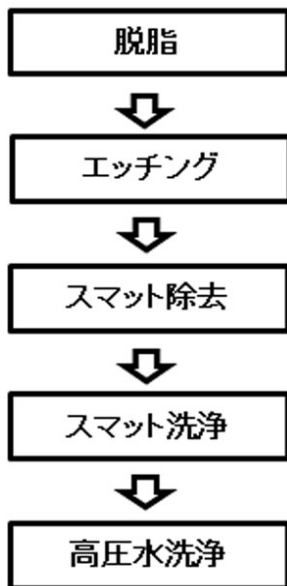
メッキ前処理工程の流れ図
